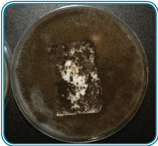
Muestra control de pieza de silicona sin BactiBlock ® : Se observa un rápido crecimiento de Aspergillus niger después de 4 semanas.
