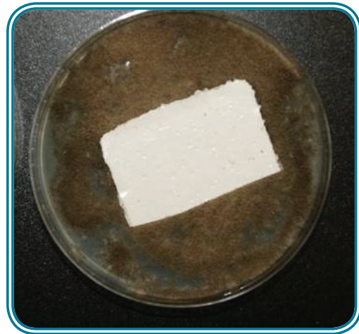
Muestra control de pieza de silicona con 3% BactiBlock ® R1.47: Se observa una eficacia elevada frente a hongos.
