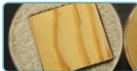
Muestra de madera con recubrimiento BactiBlock® R1.47: Eficaz contra el desarrollo de Aspergillus niger
